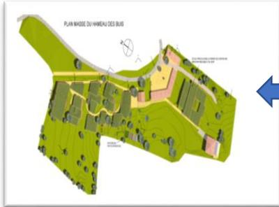
Le plan de masse présente le projet positionné sur le terrain. Il permet de vérifier que les futures constructions respectent les différentes règles d'implantation, y compris par rapport aux constructions existantes, s'il y en a. Il permet également de connaître le projet d'aménagement du terrain, l'organisation des accès à la voie publique et des branchements sur les réseaux.
